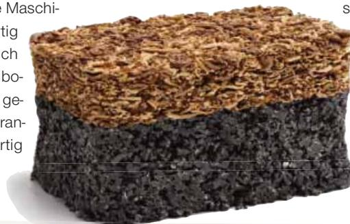
Das Material besteht zu 100% aus EPDM. Neben der natürlichen Optik und Haptik überzeugt diese Mulch-Variante durch die bewährte Melos EPDM-Qualität, die seit Jahrzehnten in diversen Sport- und Freizeitanlagen zur Anwendung kommt. Im Gegensatz zum beschichteten Gummimulch ist Melos EPDM Mulch zu 100% durchgefärbt und verliert auch mit der Zeit nicht an Farbintensität.
