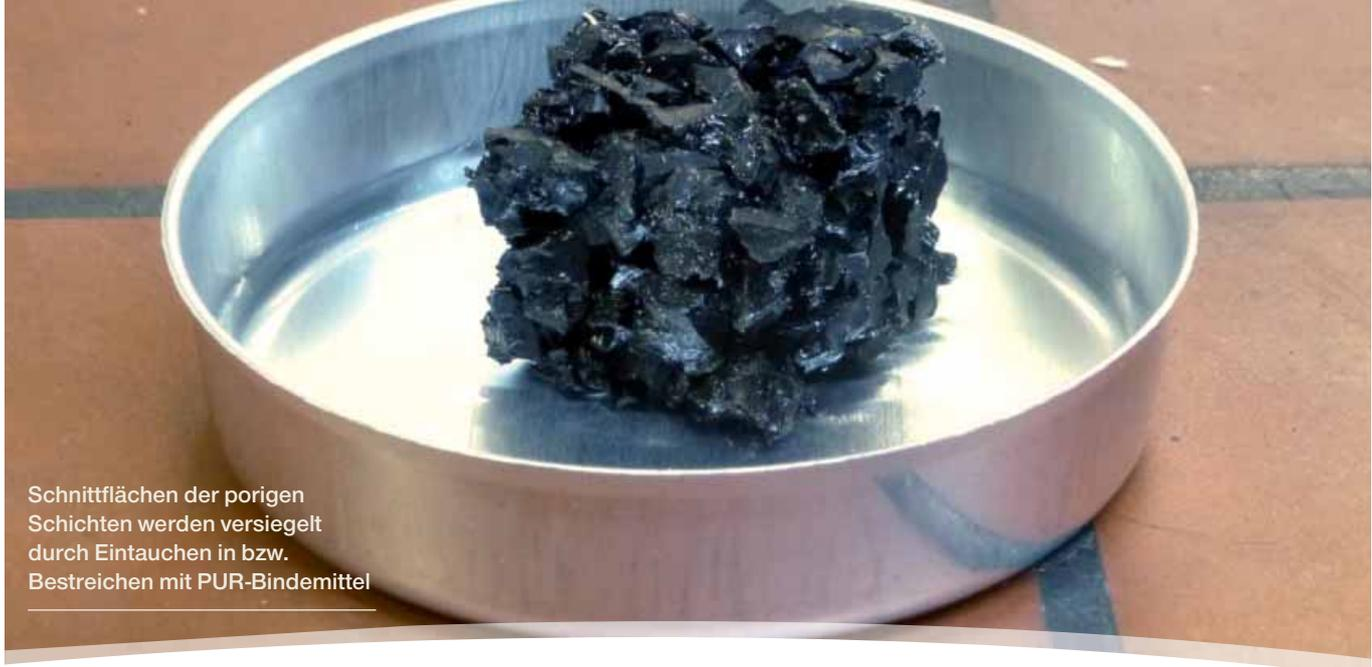
Schnittflächen der porigen Schichten werden versiegelt durch Eintauchen in bzw. Bestreichen mit PUR-Bindemittel
