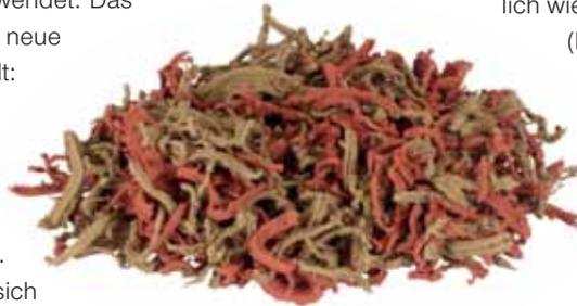
Durch die faserige Form des EPDM-Mulch entstehen beim Verarbeiten vermehrt größere Zwischenräume. Diese bieten „im Falle eines Falles“ zusätzlichen Raum für den fallenden Körper, die Be-
