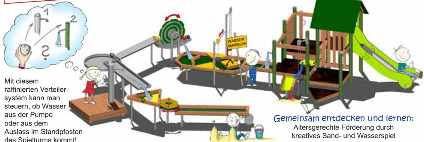
Mit diesem raffinierten Verteilernsystem kann man steuern, ob Wasser aus der Pumpe oder aus dem Auslass im Standpfosten des Spielturms kommt!
